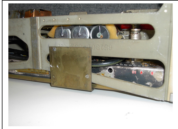
Baugruppen aus FUBA-Oszillator-Vervielfacherbaugruppen der alten 60-Ohm TV-Umsetzertechnik
