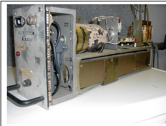
Baugruppen aus FUBA-Oszillator-Vervielfacherbaugruppen der alten 60-Ohm TV-Umsetzertechnik
